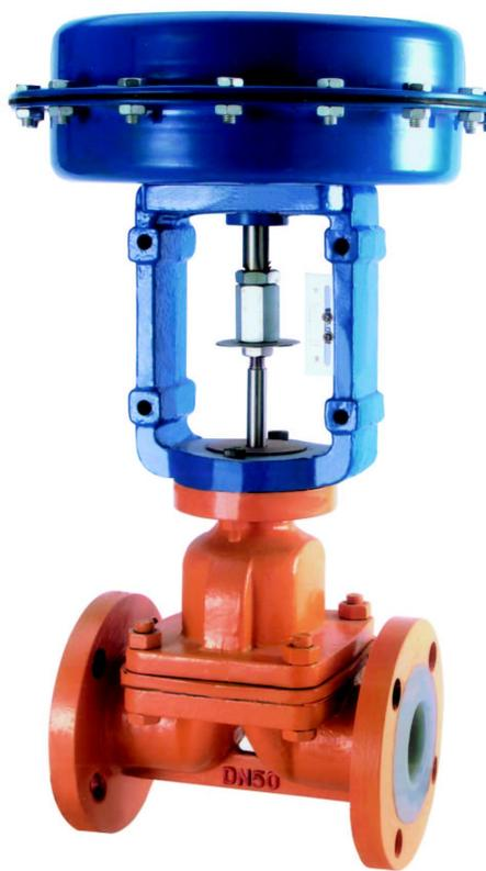
DOG 气动衬氟塑隔膜阀由气动执行机构和衬氟塑隔膜阀两部分组成。它接受调节仪表来的气源压力信号开启或关闭阀门。由于该阀门接触介质的部位采用高压注塑工艺衬有耐腐蚀、耐老化的氟塑料 FEP (简称 F46) 或 PTFE (简称 F4), 且该阀流路简单, 无填料函, 具有阻力小, 流量大的优点, 广泛适用化工、石油、冶金、医药、电力等工业自动化系统, 对强腐蚀、高粘度、含颗粒、带纤维以及有毒介质的切断和调节。
