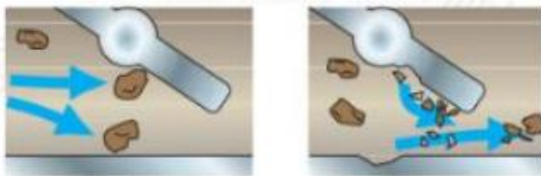
图 2 传统金属阀门工作示意图
